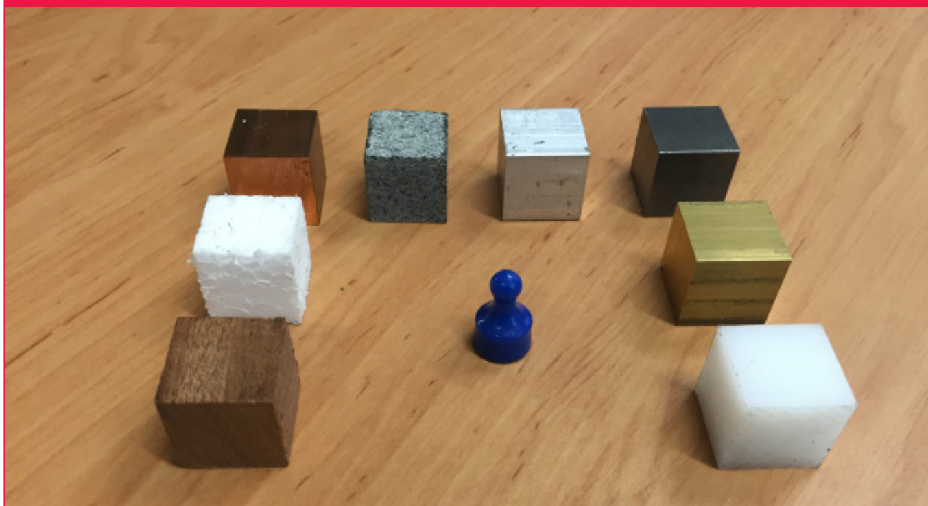
↑ Installation pour le test du magnétisme
